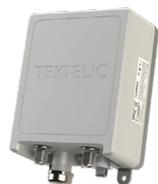
La KONA-ENTERPRISE de Tektelic est une gateway LoRaWAN outdoor ultra robuste et résistante pour une installation en extérieur. Elle dispose d'un modem 3G/4G-LTE Cat 6 intégré pour remonter les informations relevées par les capteurs IoT. Cette gateway LoRaWAN est IP67 et dispose d'interfaces avec protection contre les décharges électrostatiques et la foudre.
