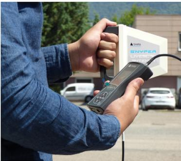
Le mode LiveScan nécessite l'antenne directionnelle jointe dans la valise. Grâce à celle-ci, vous pouvez décider d'analyser une cellule opérateur en particulier. Le scan se lancera alors et une courbe apparaîtra et évoluera en temps réel en fonction de la fluctuation du signal. L'antenne directionnelle permet de pointer le signal en tournant à 360°.
